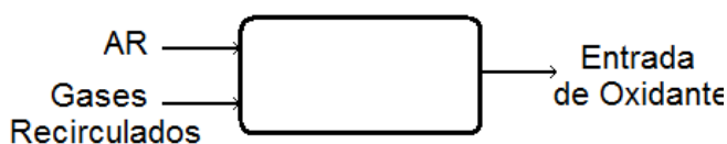
Figura 23: Volume de controle para a mistura.
